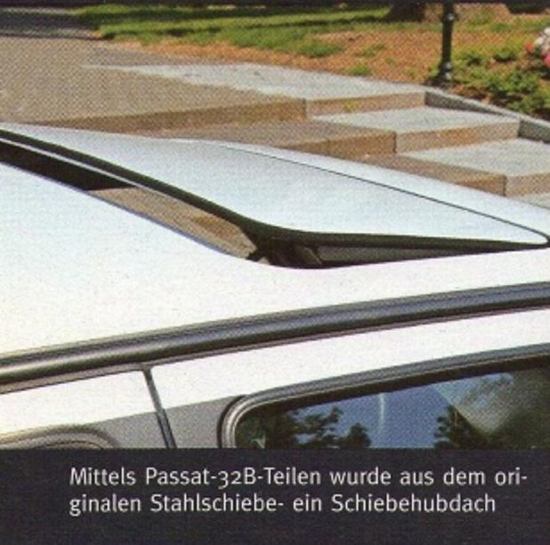
Mittels Passat-32B-Teilen wurde aus dem originalen Stahlschiebe- ein Schiebehubdach
